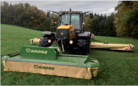
Mähkombination bestehend aus einem Krone EC32 Frontmäherwerk sowie einem Krone EC9000 Flügelmäherwerk im Heckanbau, dies ermöglicht eine Arbeitsbreite von 8,7 m.
