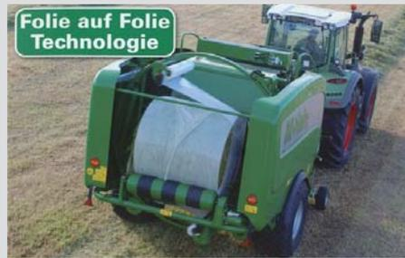
Bei dieser Rundballenpresse wird statt Netz Folie verwendet. Die Mantelfolie dient als zusätzliche Wickellage bei dichteren Ballen, ermöglicht leichteres Öffnen und einfaches Recycling. Einsetzer: Spiegelberger Josef, Leitenberg, Frasdorf, Tel. 08052/4444
